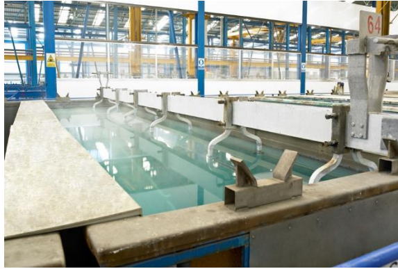
Ilustración 68 Proceso de sellado del anodizado, Tomado de Grupoandalucia.org, 2012.
