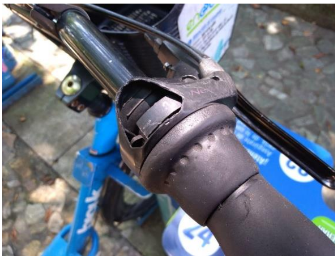
Ilustración 48 Maneta de cambios en pésimo estado "EnCicla", Foto tomada por el autor, 2018.
