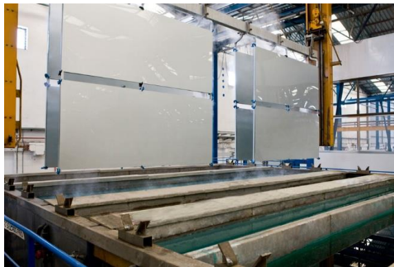
Ilustración 67 Proceso de anodizado y coloración, Tomado de grupoandalucia.org, 2012.
