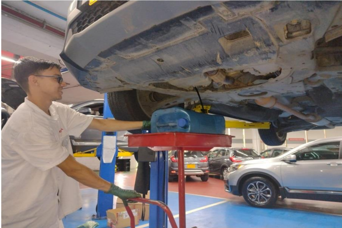
Figura 3. Cambio aceite de motor y filtro.
