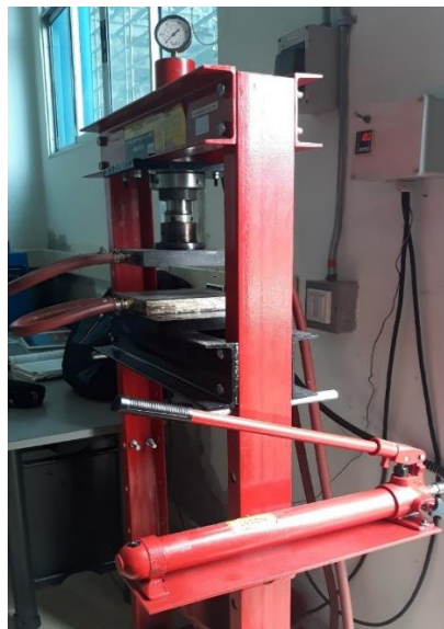
Figura 9. Moldeo por compresión en prensa hidráulica - palanca de accionamiento.
