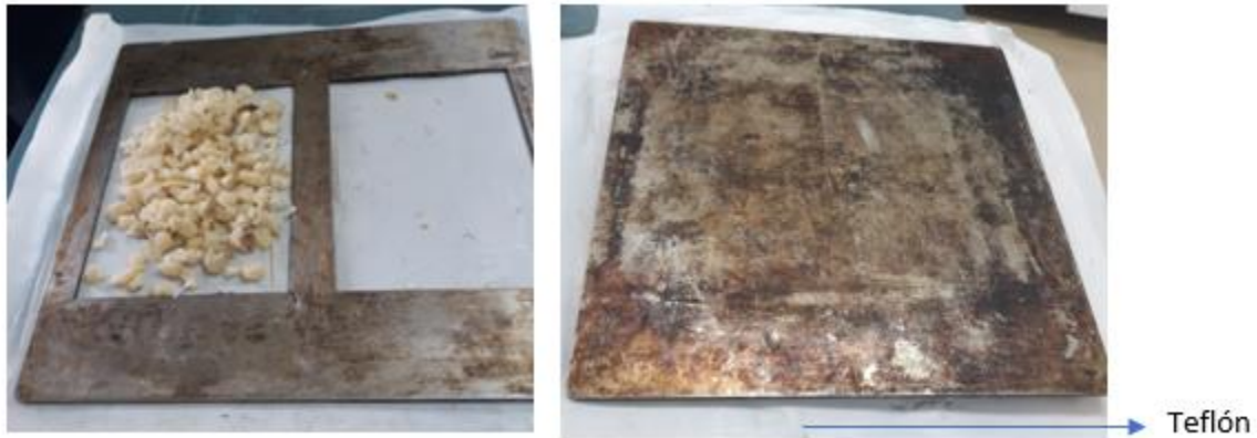
Figura 8. Disposición del material en placa molde para comprimir
