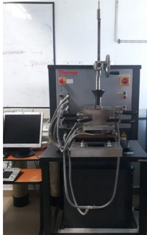
Figura 1 Reómetro de torque (RDT) en laboratorio de polímeros, parque i, ITM
