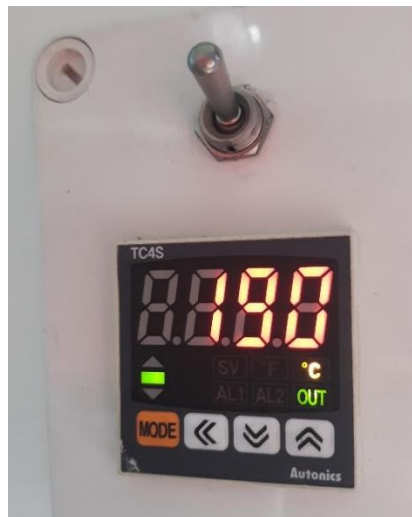
Figura 7. Temperatura seleccionada para moldeo por compresión.
