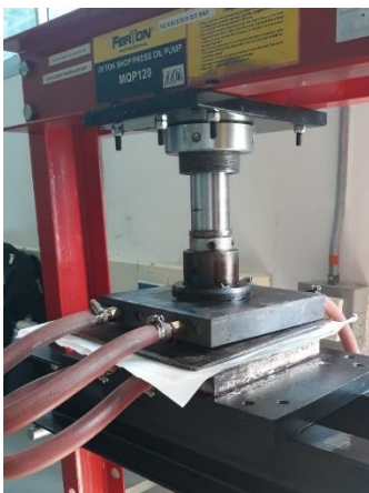
Figura 11. Mangueras para distribución de líquido refrigerante.
