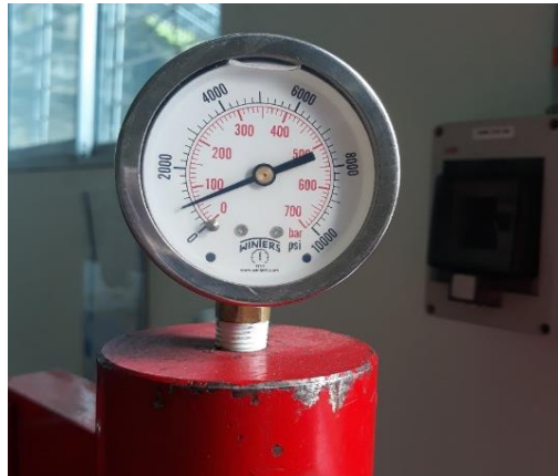
Figura 10. Presión de sostenimiento necesaria para el moldeo por compresión
