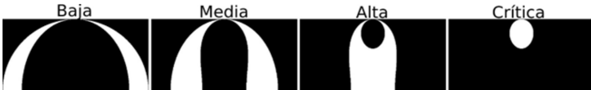
Figura 10. Máscaras utilizadas para realizar la segmentación según las diferencias de esfuerzos presentes en el disco.
