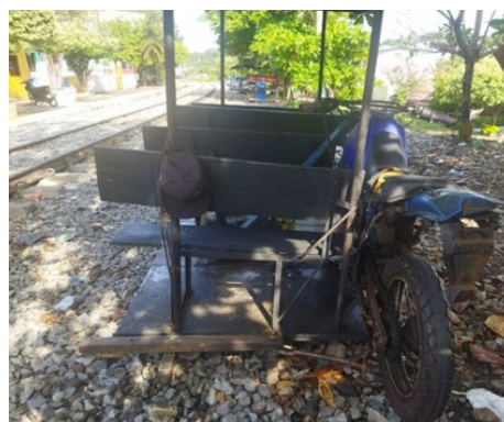
Figura 2. Vista posterior de los ensamblados improvisados del mobiliario y la carencia de elementos de seguridad de las Moto-Mesas actuales. Autoría: Kelly Johanna Pineda Duque
