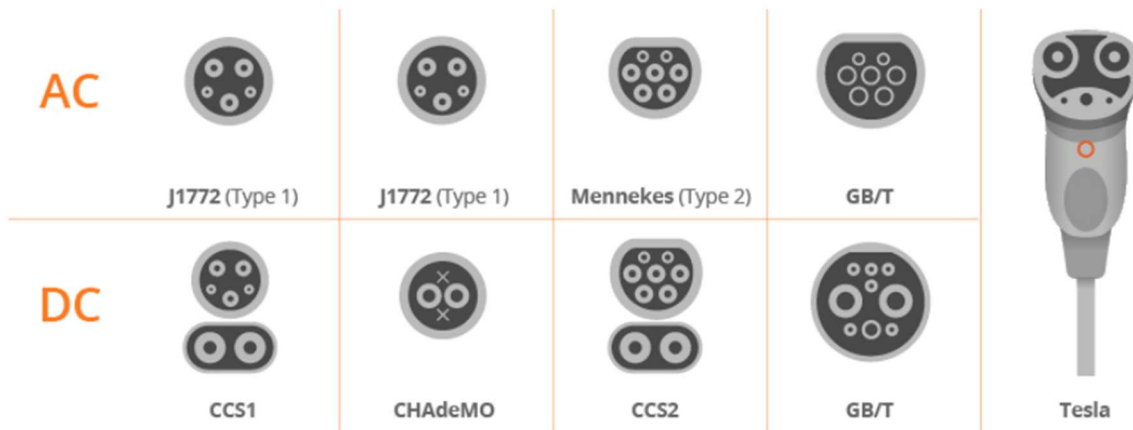
Figura 22 Esquema con los tipos de conectores (UPME, 2019)
