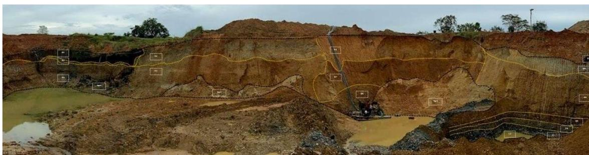
Figura 2.3. Identificación de estratos expuestos en frente de explotación de WGM. La inclusión de esta imagen es ilustrativa, el detalle de los estratos se describe en la Tabla 1.
