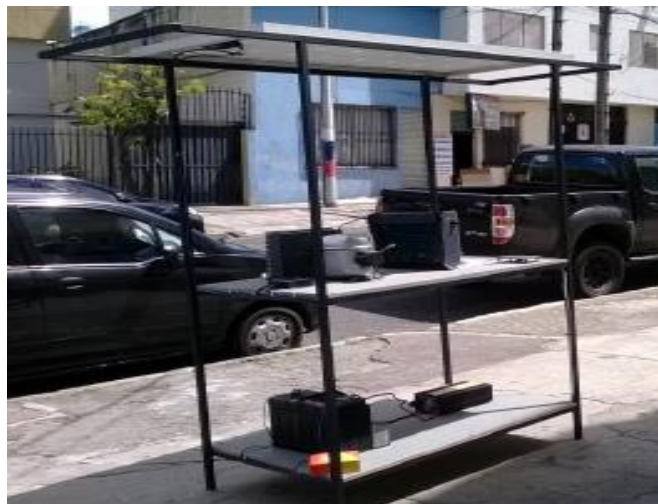
Figura 12. Estructura diseñada con los componentes básicos de un sistema de aire acondicionado automotriz para pruebas de funcionamiento.
