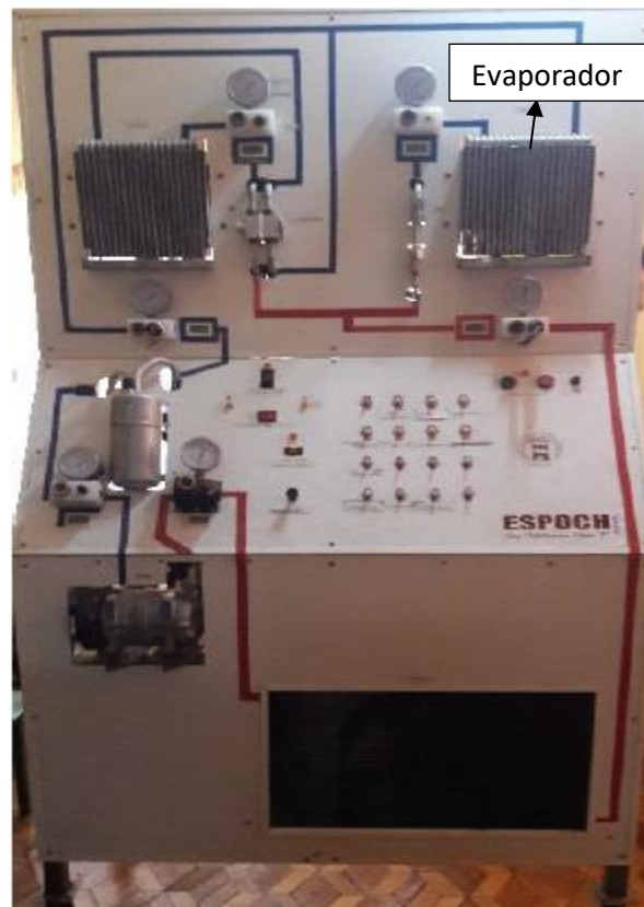
Figura 13. Banco de sistema de refrigeración automotriz. Fuente: (Angulo & Muñoz, 2017).
