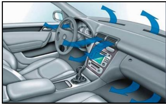
Figura 9. Distribución del aire dentro del habitáculo. Fuente: (Nois, 2017).
