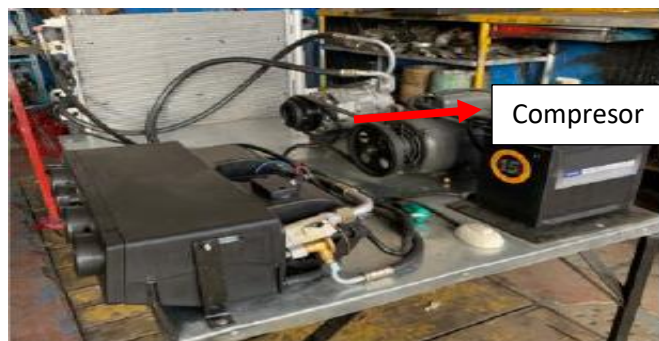
Figura 8. Banco de pruebas utilizado para evaluar el desempeño de los compresores Tahoe.
