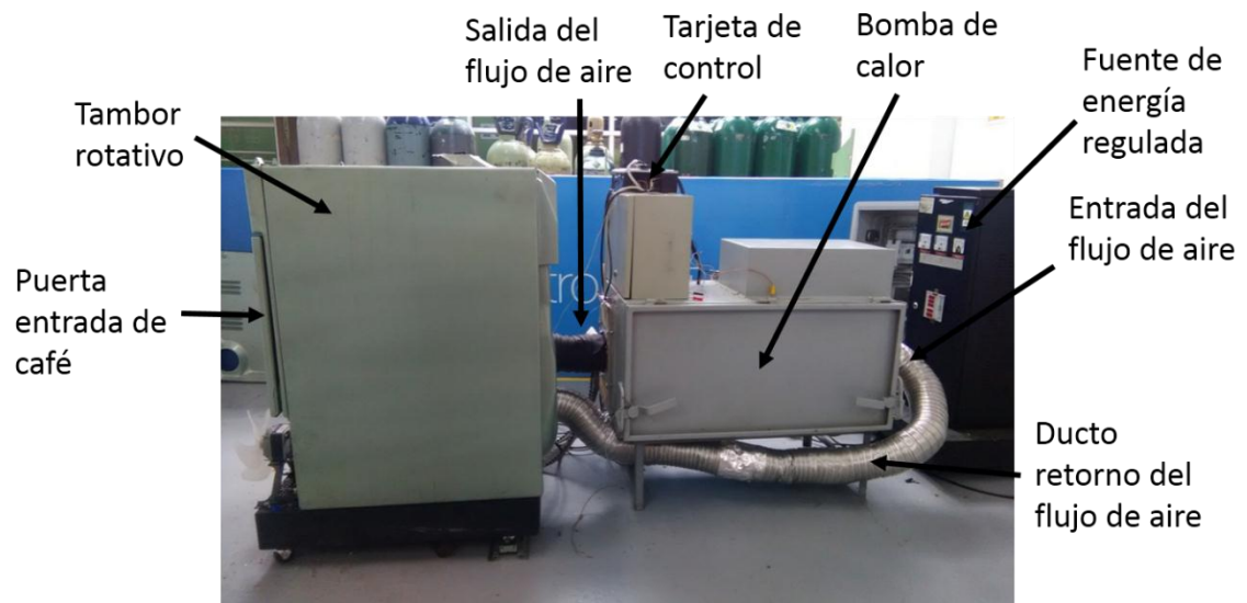
Figura 2-13 Ensamble de los subsistemas, montaje real fuente: autor
