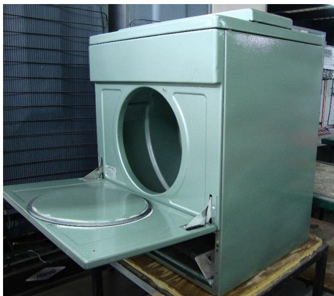
Figura 2-9 Ensamble del Tambor rotativo Fuente: Autor
