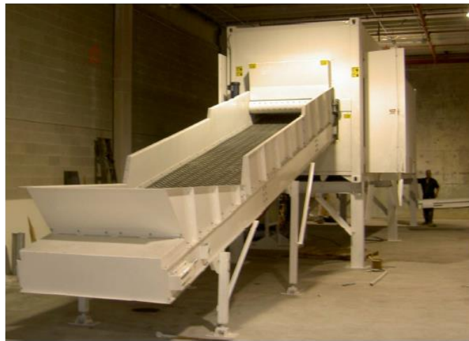
Imagen 3. Alimentador del sistema de reciclaje para yeso de "Andela Products". Modelo AGBR
