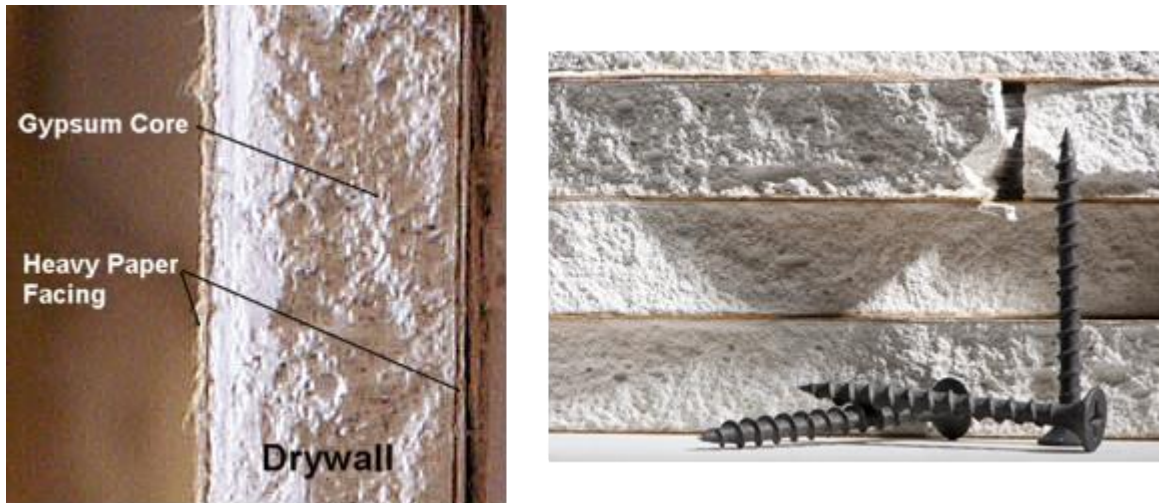
Ilustración 2. Composición placa de yeso o drywall
