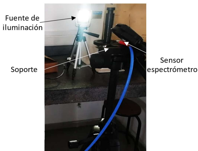
Figura 2-10: Medida de la respuesta electromagnética en lámpara fluorescente. Autoría propia.
