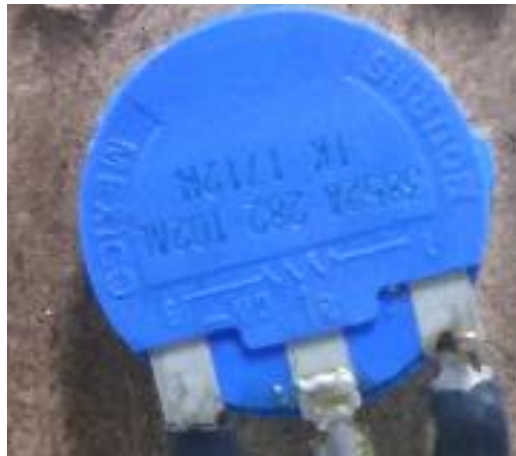
Figura 53 Potenciómetro como sensor de posición angular.
