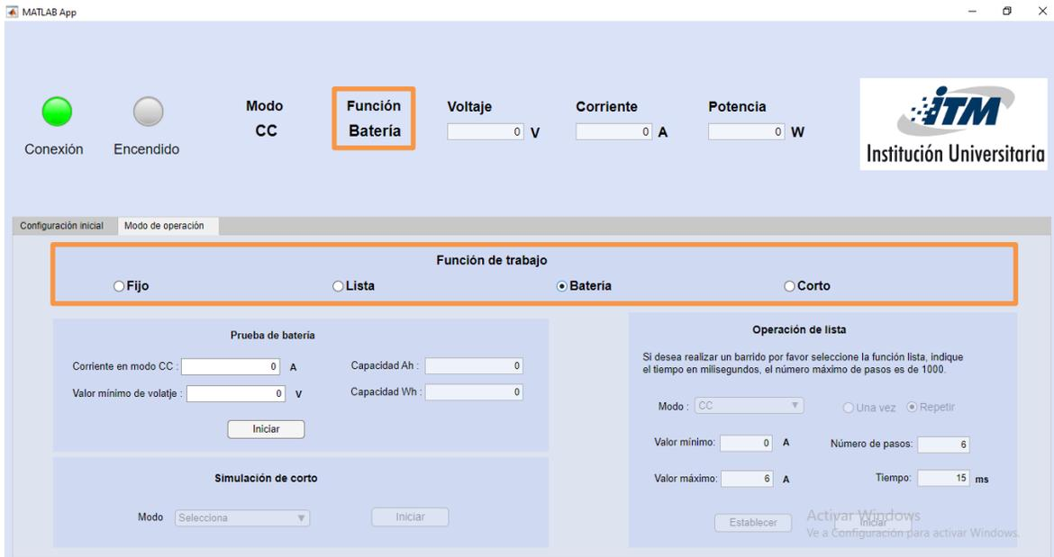
Figura 15. Establecer y leer la función de operación desde la interfaz gráfica (Para este caso la carga se encontraba en función de lista y se cambió para la función de prueba de batería).
