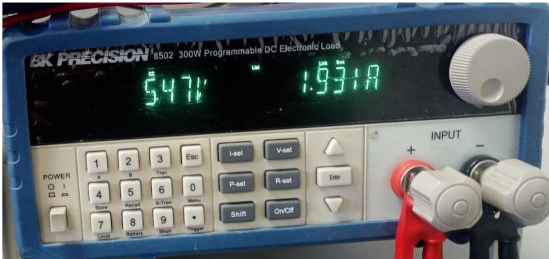
Figura 35. Valores de voltaje y corriente de una lista en modo CC leídos desde la pantalla de la carga electrónica.
