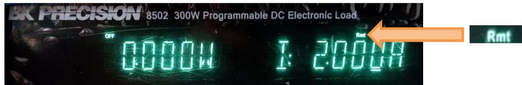
Figura 6. Indicador Remoto visto desde la pantalla de la carga electrónica.
