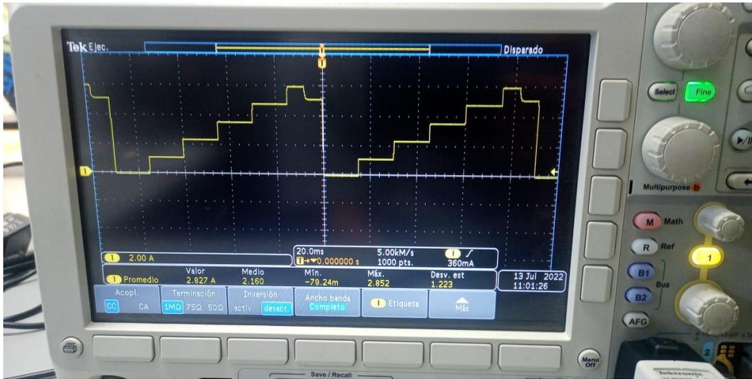
Figura 36. Gráfica de una lista en modo CC vista desde un osciloscopio.
