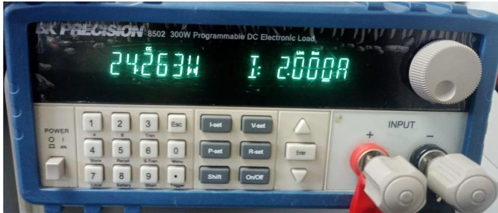
Figura 10. Valores de potencia y corriente leídos al encender la carga, vistos en la pantalla del instrumento.
