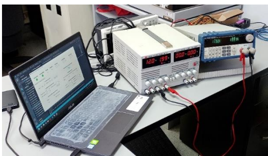
Figura 2. Espacio de trabajo en el laboratorio – Computador, fuente de alimentación DC y carga electrónica de la serie BK Precision 8502.
