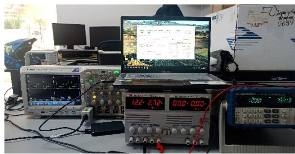
Figura 3. Espacio de trabajo en el laboratorio – Computador, fuente de alimentación DC, carga electrónica de la serie BK Precision 8502 y osciloscopio.
