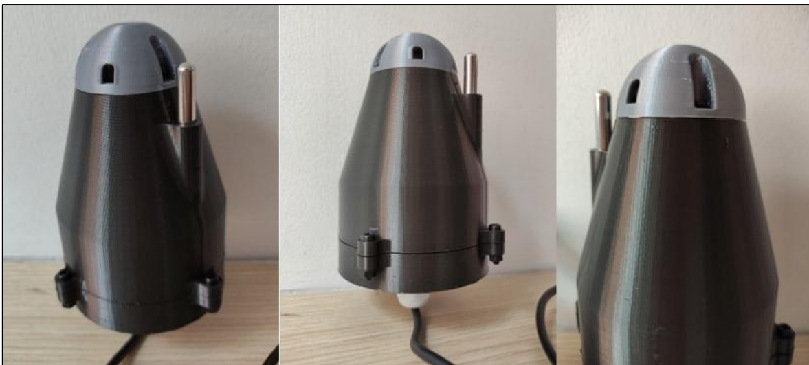
Figura 12. Ensamble final de la sonda de turbidez.
