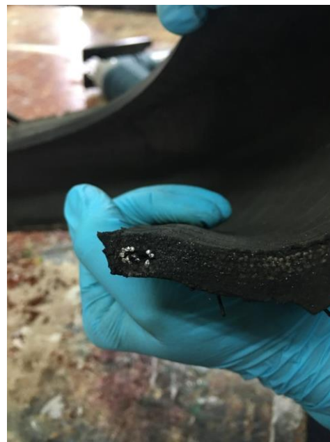
Figura 40. Aglomeración de filamentos metálicos. Llanta de moto. Fuente: Autoría propia
