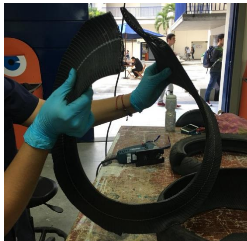
Figura 38. Corte radial, llanta de carro. Fuente: Autoría propia
