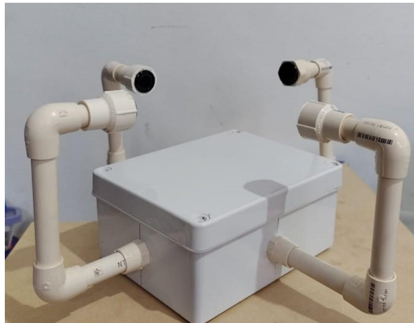
Figura 11. Estructura que soporta los sensores, vista frontal.
