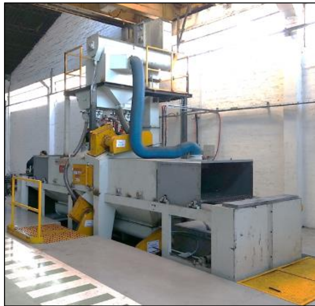
Ilustración 8. Granalladora GB01 Bonem (Fuente propia)
