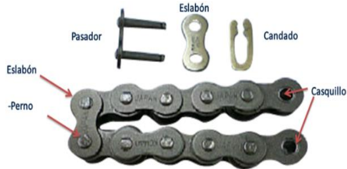
Figura 12. Componentes de una cadena de rodillos.
