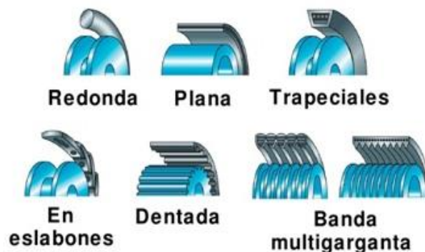
Figura 11. Tipos de correas según su geometría.
