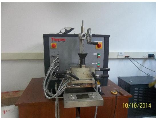
**Figura 8. Reómetro de torque Thermo Scientific**
