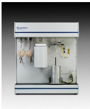
**Figura 6. Equipo ASAP 2020 de Micromeritics**
