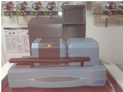
Figura 7. Analizador térmico TGA SDT Q600
