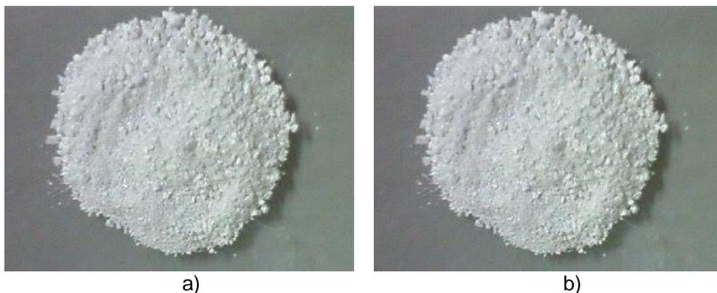
Figura 13. Fotografía de la Zeolita ZSM-5 obtenida en el laboratorio de polímeros de ITM. a) 48h, b) 120h
