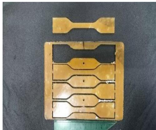
Figura 11. Probetas de tensión elaboradas
