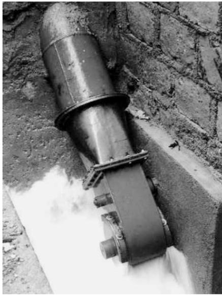
Figura 7. Turbina de flujo cruzado de bajo costo en India. Esta máquina de 5 KW, diseñada y difundida por IT Power en el Reino Unido, es usada para trillar arroz y generación de electricidad.
