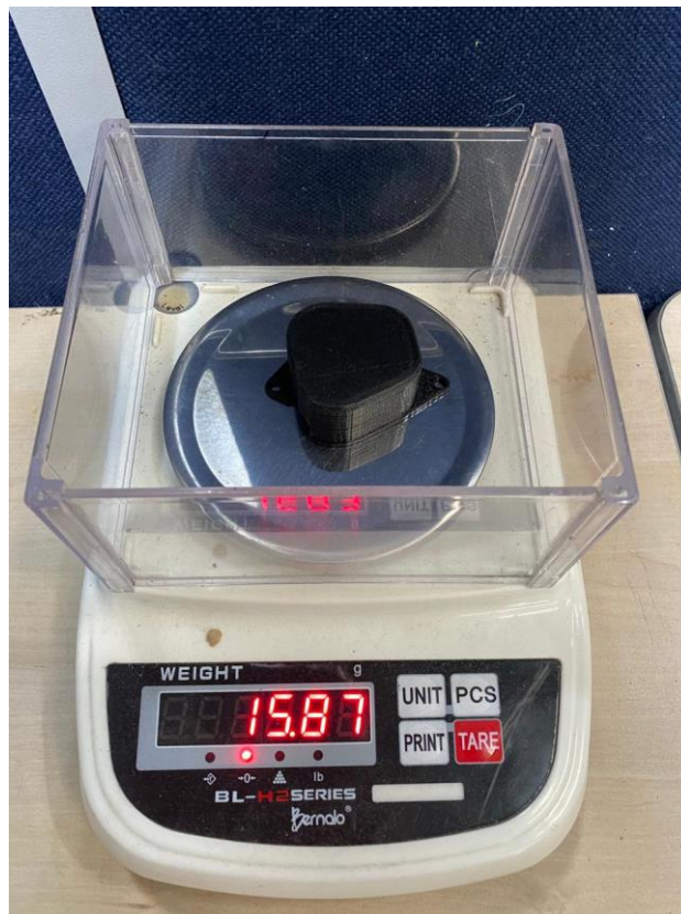
Figura 19, Peso de la cubierta de potenciómetro de danzarina impresa en 3D, tomada de fuente propia.
