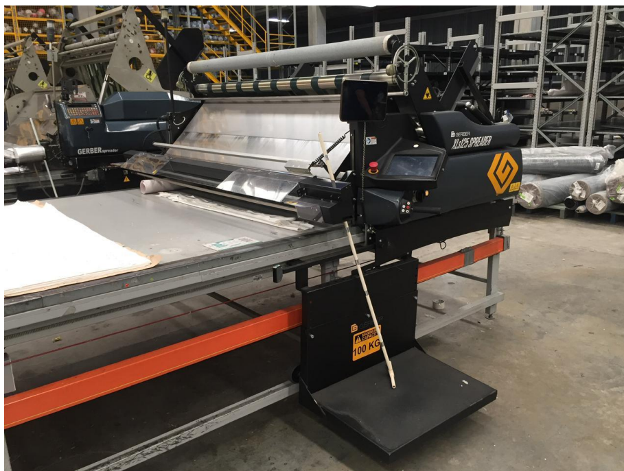
Figura 5, Máquina extendedora de tela XLS125 de Gerber Technology, tomada de fuente propia.
