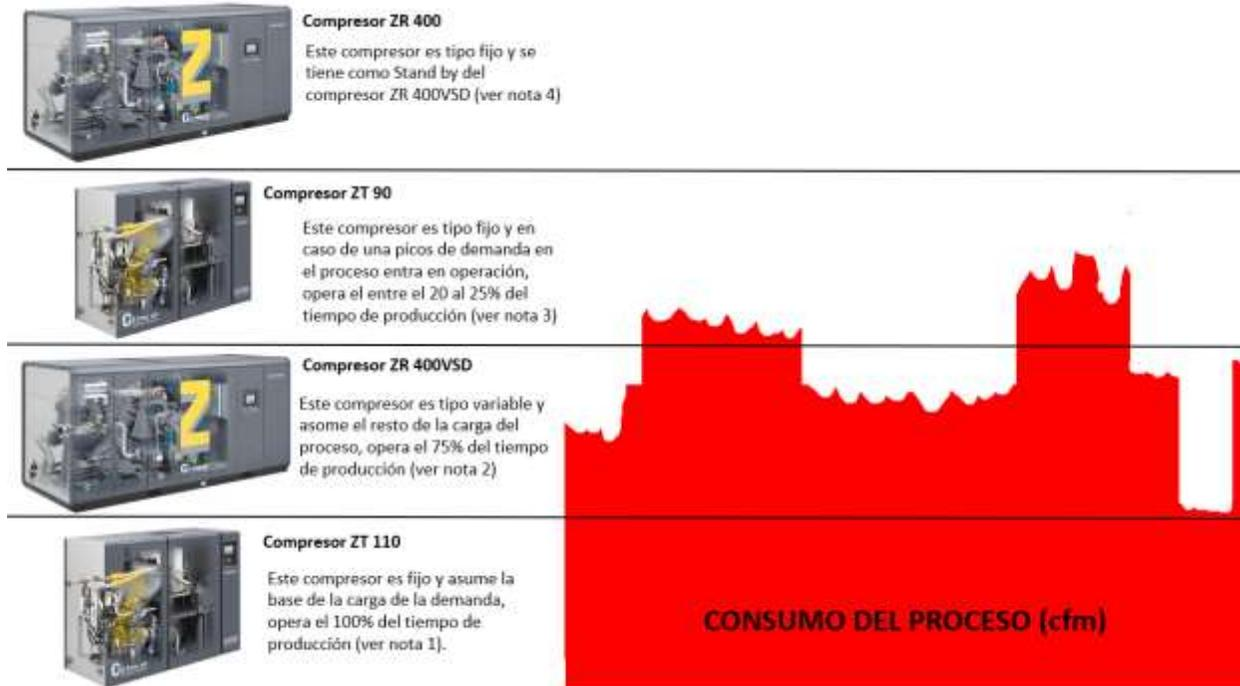
**Ilustración 27. Operación de Proceso de Generación Aire comprimido RENAULT Sofasa
