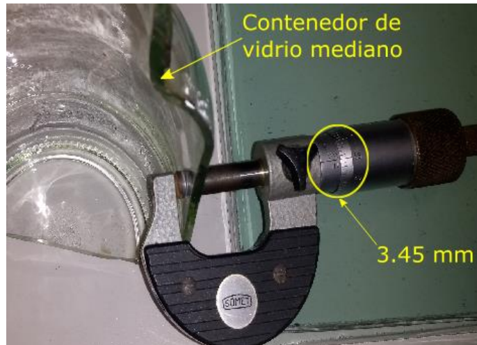
Figura 5-5 Medición de espesor con micrómetro en contenedor de vidrio curvo mediano
