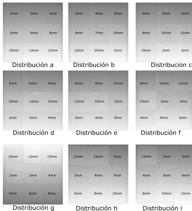
Figura 3-17 Imágenes de profundidad filtradas de las muestras de vidrios planos transparente a una distancia de 1100 mm
