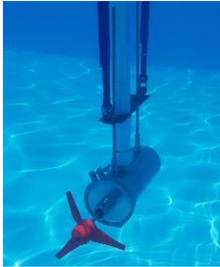
Figura 20. Rotor y carcasa hermética sumergidos en la piscina. Fuente: autor.
