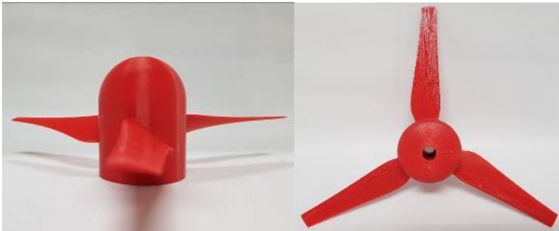
Figura 52. Rotor NACA 4412 con manufactura aditiva. Fuente: autor.
