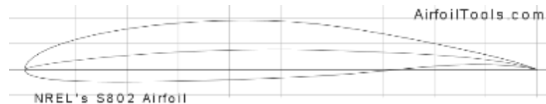
Figura 13. Perfil NREL S802. Fuente: Airfoil tools [11].
