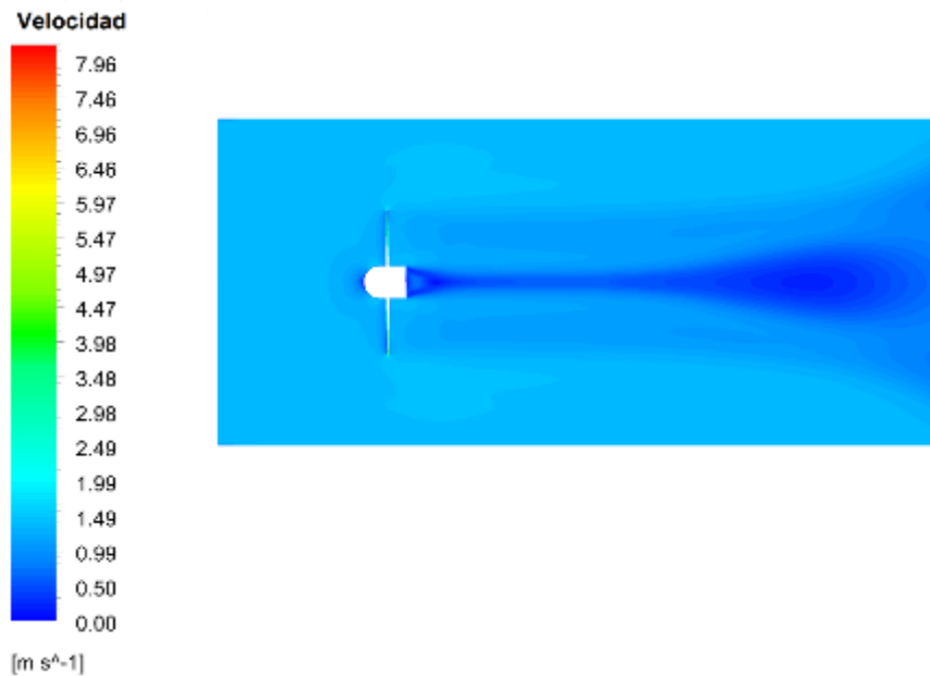
Figura 41. Perfil de velocidad de rotor construido con NACA 4412. Fuente: autor.
