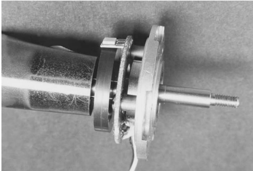
Fig.6. Rotor que muestra las transiciones de polos magnéticos BLDC. [1]
