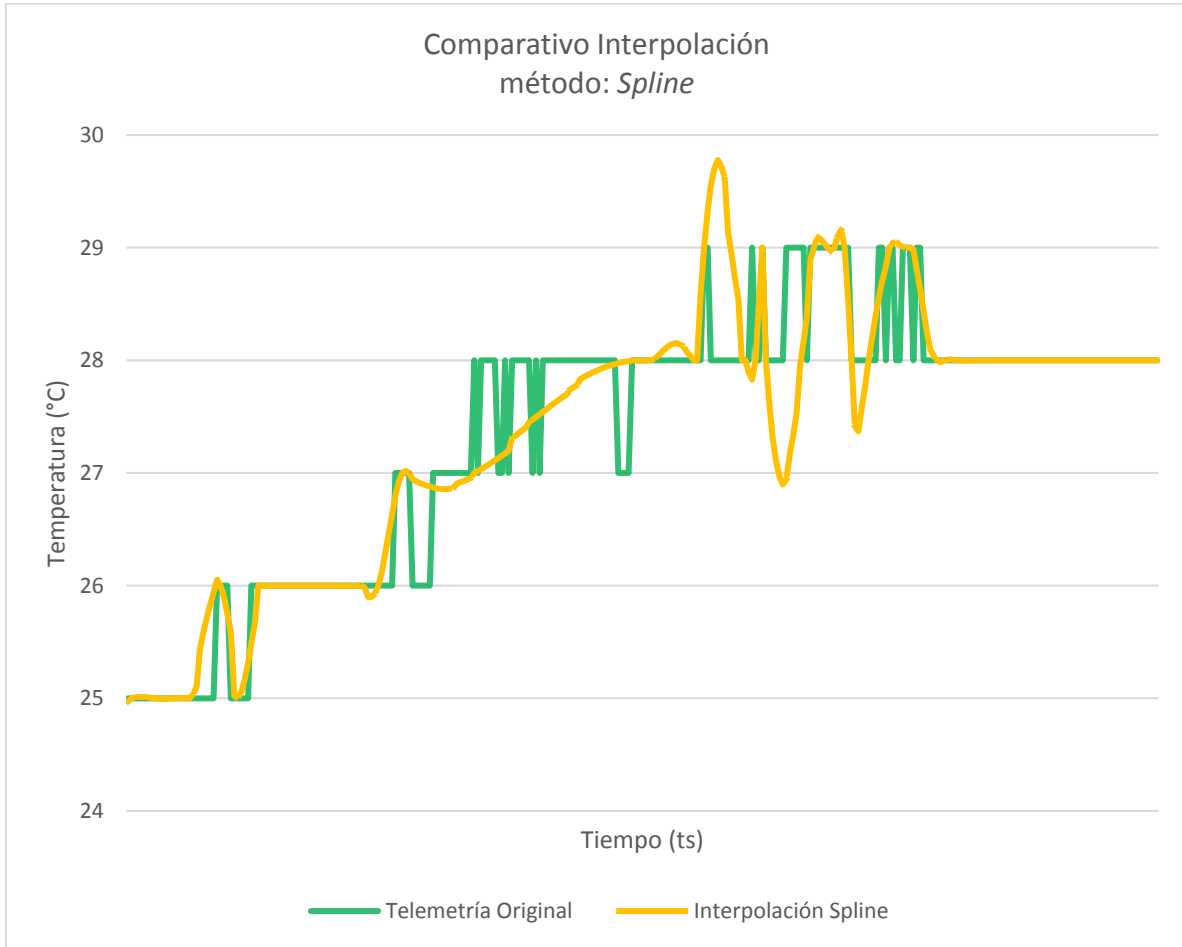
Gráfico 7. Comparativo entre valores de telemetría original y valores generados a partir del método de interpolación Spline para el rango de números aleatorios entre 0 y 6.
