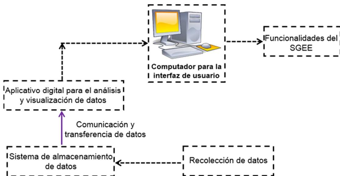
Figura 7. Componentes estructurales involucrados en un SGEE. Fuente: Autor
