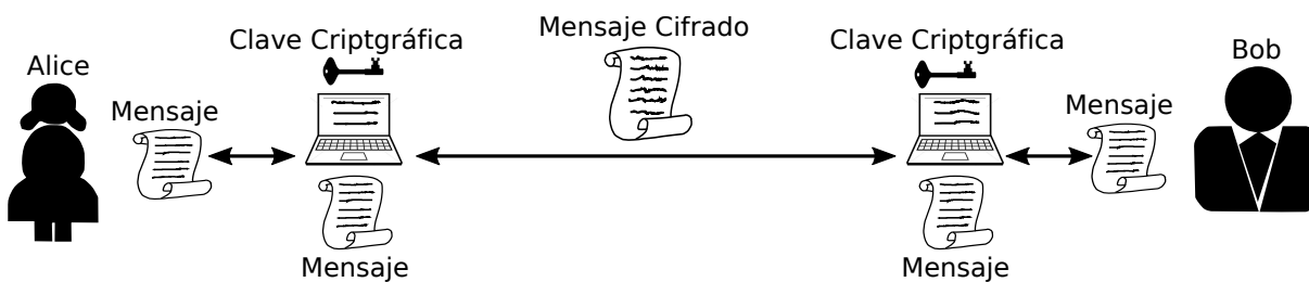
Figura. 2.4 Cifrado simétrico: El emisor Alice Y el receptor Bob comparten la clave para cifrar y descifrar los mensajes. Para el proceso de cifrado, Alice o Bob codifica el mensaje, el que recibe la información decodifica con la misma clave.
