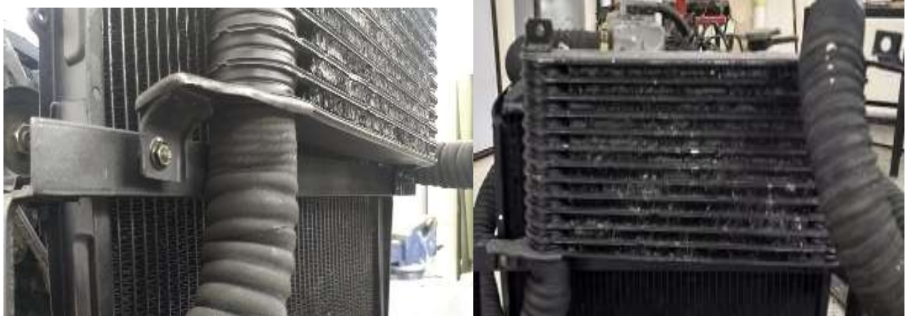
Figura 22. Soporte del intercambiador de calor implementado en el motor KIA – K2 del banco de pruebas del laboratorio de ciencias térmicas del ITM. Fuente: Autores.
