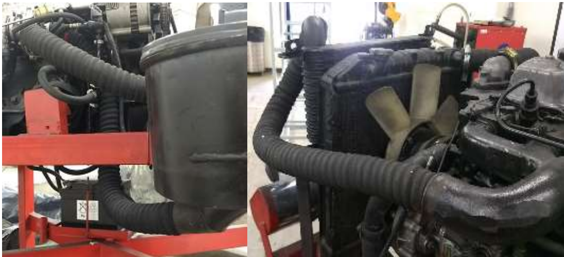
Figura 25. Ruteo de mangueras del aire desde la toma a presión atmosférica, hasta la admisión del aire al motor a mayor presión. Fuente: Autores
