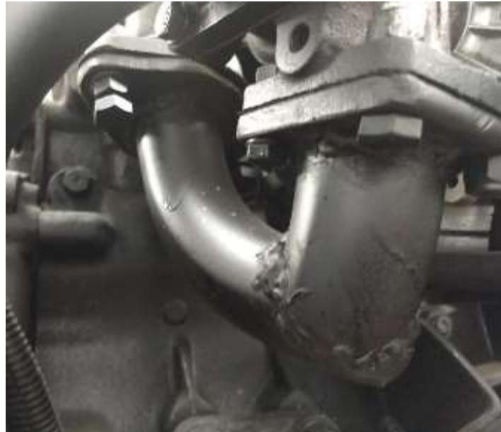
Figura 19. Base de acoplamiento de múltiple de escape con el turbo cargador instalado en el motor KIA – K2 del banco de pruebas del laboratorio de ciencias térmicas del ITM. Fuente: Autores.
