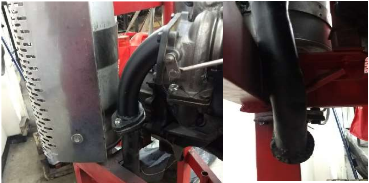
Figura 21. Motor KIA – K2 del banco de pruebas del laboratorio de ciencias térmicas del ITM, con la modificación del sistema de escape del para que pase por debajo del chasis. Fuente: Autores.
