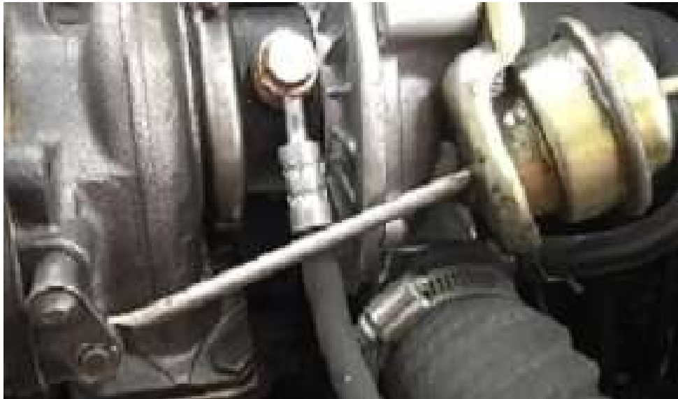
Figura 26. Válvula de alivio del turbo cargador instalado en el motor del banco de pruebas del laboratorio de ciencias térmicas del ITM. Fuente: Autores.
