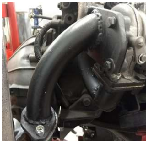
Figura 20. Salida de sistema de escape modificado e implementado en el motor KIA – K2 del banco de pruebas del laboratorio de ciencias térmicas del ITM. Fuente: Autores.
