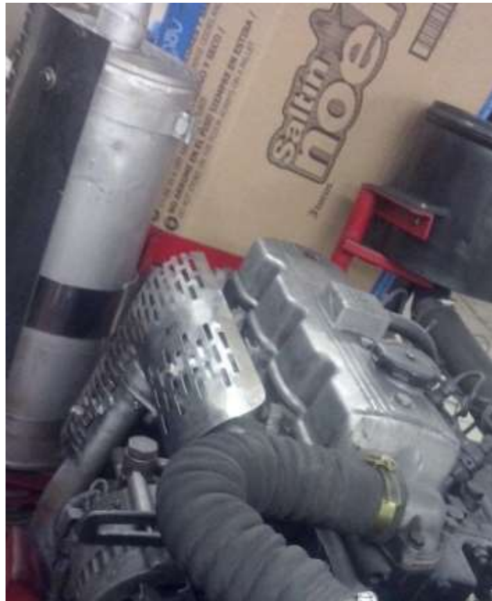
Figura 18. Sistema de escape existente perteneciente al motor KIA – K2 del banco de pruebas del laboratorio de ciencias térmicas del ITM. Fuente: Autores.
