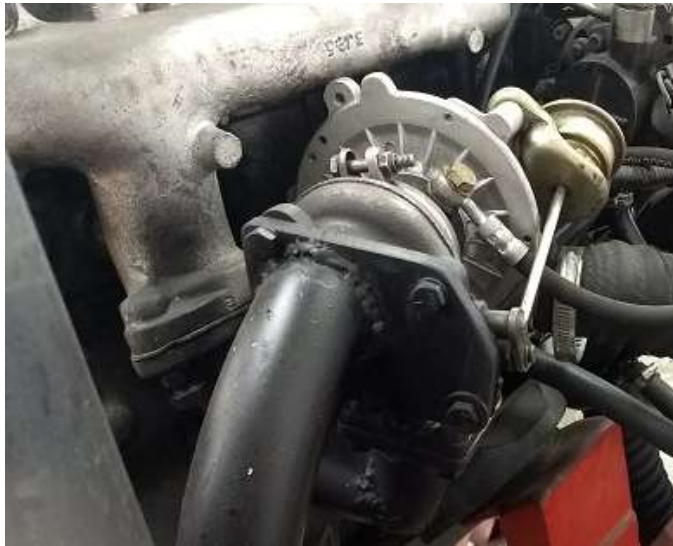
Figura 27. Acoplamiento del turbo cargador a los múltiplos de escape y de admisión. Fuente: Autores.
