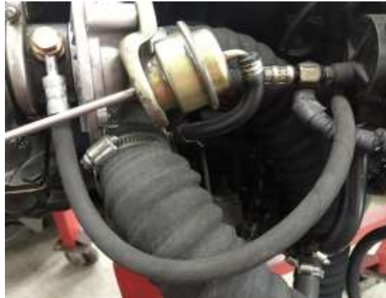
Figura 28. Implementación de la manguera de lubricación turbo cargador al bloque del motor. Fuente: Autores.
