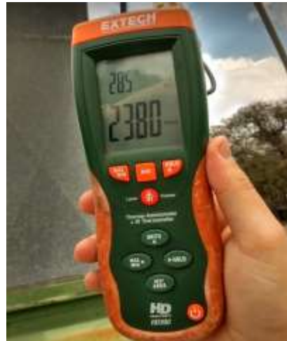
Medición cfm caudal de aire extractor # 2
