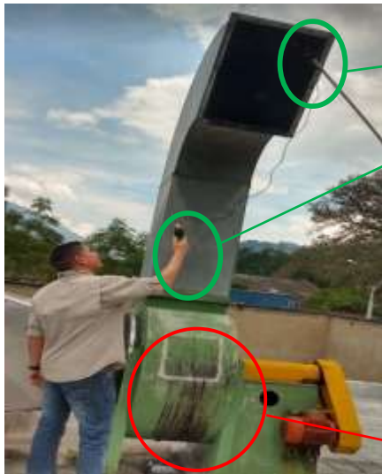
Imagen 41. Toma de mediciones a la salida de la campana
