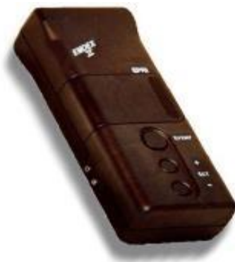
Figura 4. Equipo EMDEX II para la medición de campos magnéticos de baja frecuencia.
