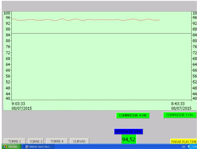
**Fig. 18.** Screen curva de la presión de aire. Fuente: Autor
