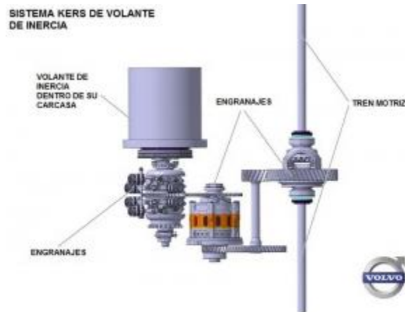
figura 18. Muestra el sistema Kers en automóvil de la fórmula 1. Fuente: (Gutiérrez-Benjumea, 2017)
