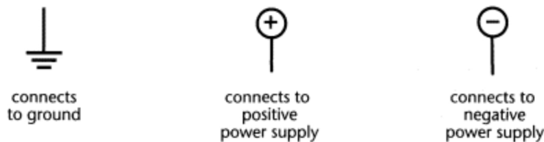
Figura 11: Voltaje y tierra.
