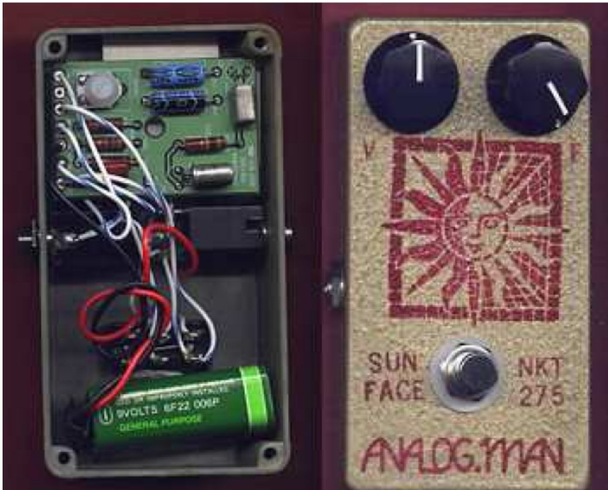
Figura 17: Un ejemplo moderno del circuito del Fuzz Face y su caja.
