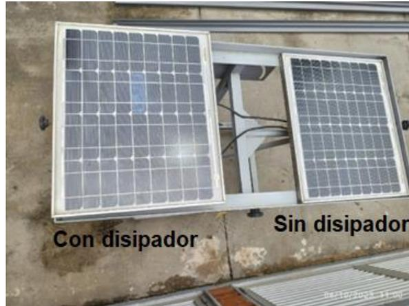
**Figura 24.** Montaje de paneles fotovoltaico en estructura.
