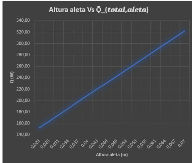
**Figura 35.** Tabla y gráfica de altura de la aleta vs  $\bar{Q}_{total, aleta}$ .
