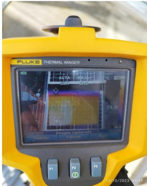
**Figura 28.** *Medición de temperatura panel fotovoltaico sin disipador.*
