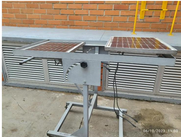
**Figura 25.** *Paneles fotovoltaicos en estructura*
