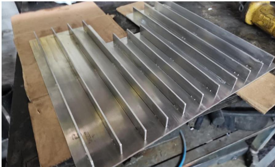
**Figura 16.** *Disipador real terminado.*
