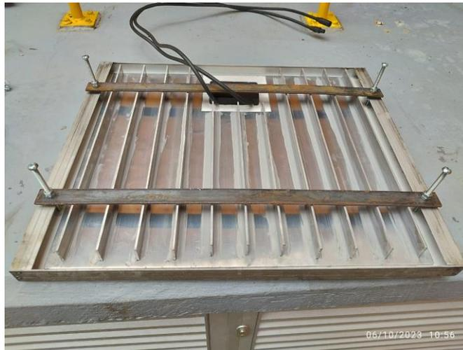
**Figura 23.** Sujeción del disipador y el panel fotovoltaico.
