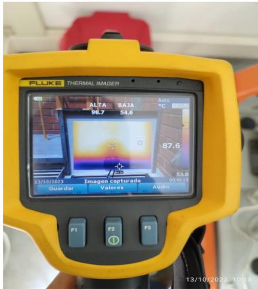
**Figura 29.** *Medición de temperatura panel fotovoltaico parte inferior sin disipador.*
