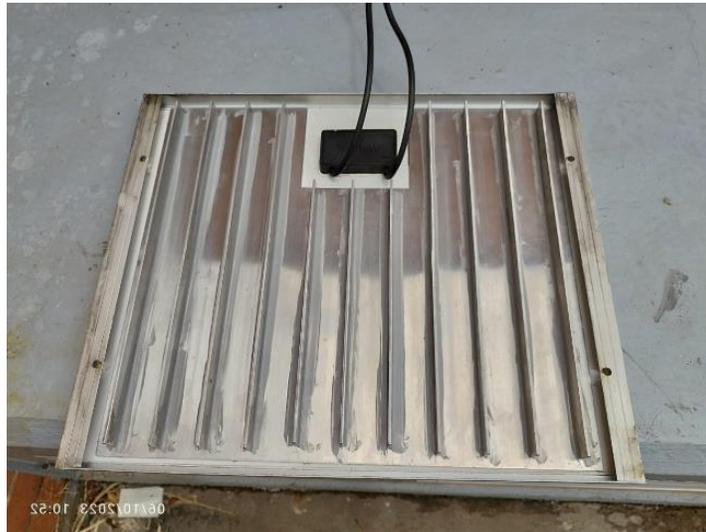
**Figura 21.** *Disipador instalado en el panel fotovoltaico.*
