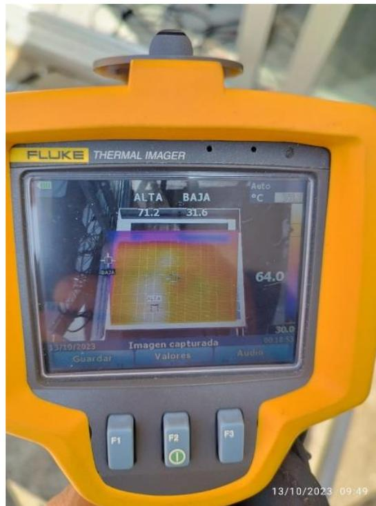
**Figura 27.** *Medición de temperatura panel fotovoltaico con disipador.*
