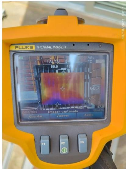
**Figura 30.** *Medición de temperatura panel fotovoltaico parte inferior con disipador.*
