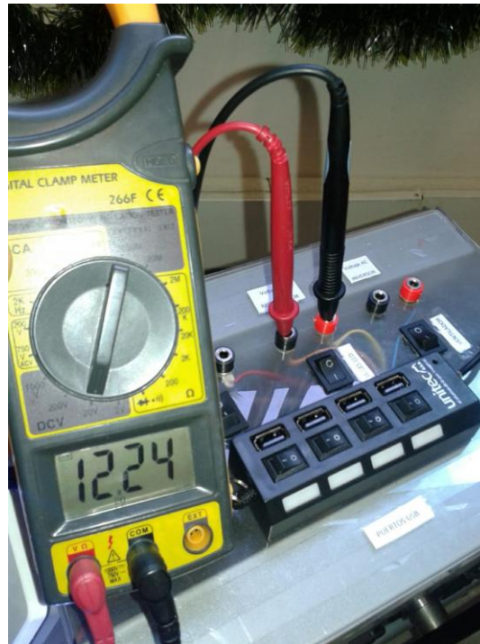
Figura 33. Medida de DC despues del Rectificador Trifásico.
