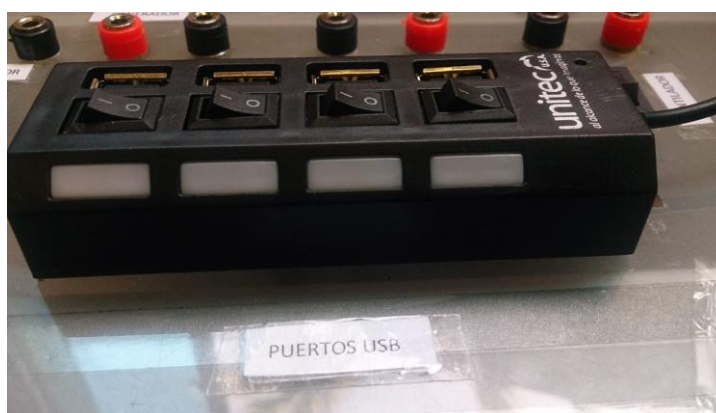
Figura 31. Puertos USB conectados al Inversor.
