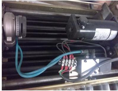
*Figura 17. Motor Iron Horse Vagones QUANTUM.*
