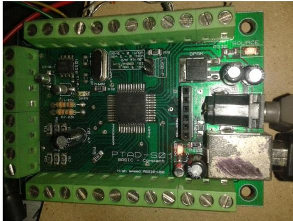
Figura 5. Tarjeta de adquisición de datos PTAD-S01
