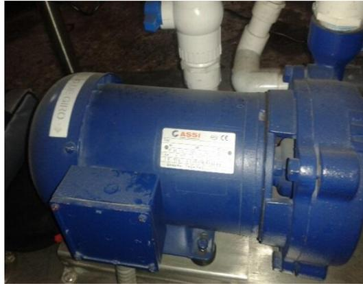
Figura 1. Motor trifásico ASSI
