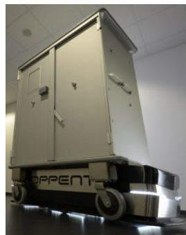
Ilustración 11. Vehículo de guiado automático para hospitales.
