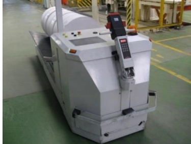
Ilustración 9. AGV, transportador de bobinas.
