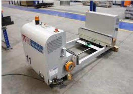
Ilustración 6. AGV, transportador de carga ligera.
