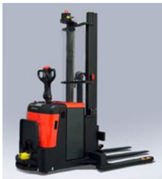
Ilustración 3. AGV, transportador unitario de cargas.
