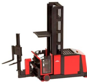
Ilustración 8. AGV, carga trilateral.
