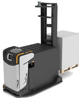
Ilustración 5. AGV de tipo monta-carga de horquilla.
