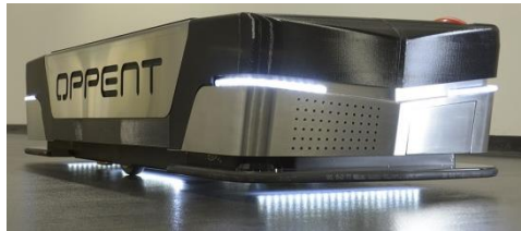
Ilustración 1. Vehículo de guiado automático, desarrollado por la empresa OPPENT, para el movimiento dentro de instalaciones clínicas.
