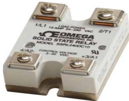
Figura 12. (Relés de estado sólido omega SSRL240AC10. programable S7-1200 12, técnica de automatización. F. Ebel, S. Idler, G. Prede, 2008)
