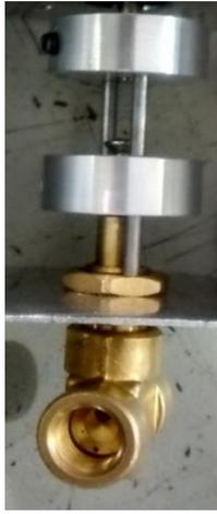
**Imagen 7. Buje elaborado en el laboratorio de máquinas y herramientas, el cual cumple la función de unir el eje del motor con el vástago de la válvula.**
