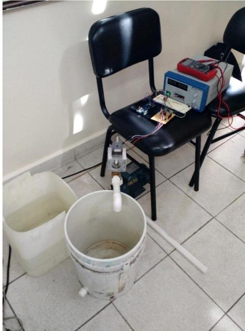
**Imagen 15. Pruebas con la electroválvula tipo compuerta en la planta piloto para hallar su curva característica.**
