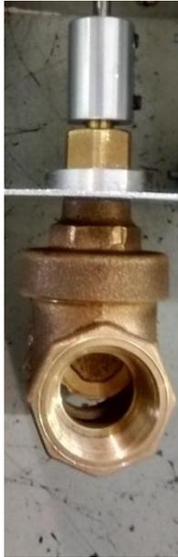
**Imagen 6. Buje elaborado en el laboratorio de máquinas y herramientas; el cual cumple la función de unir el eje del motor con el vástago de la válvula.**
