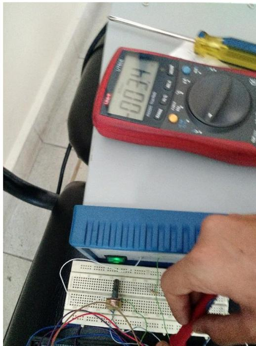
**Imagen 16. Variación del voltaje de 0 a 10v para calcular el caudal que tiene a 0v, 1v, 2v, 3v, 4v...**
