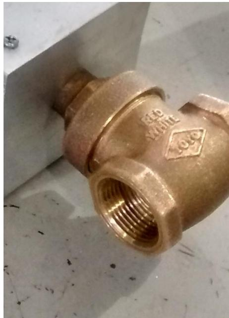
**Imagen 2. Válvula de compuerta.**
