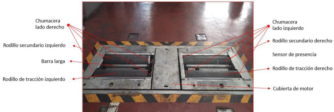
Figura 17. componentes del frenómetros de rodillos (BRAK7000). Elaboración propia
