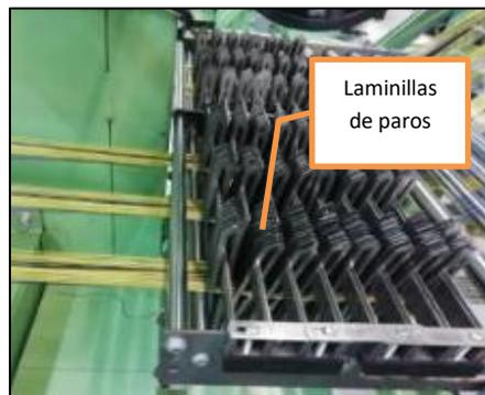
**Figura 35** Paso de hilos por laminillas de paros
