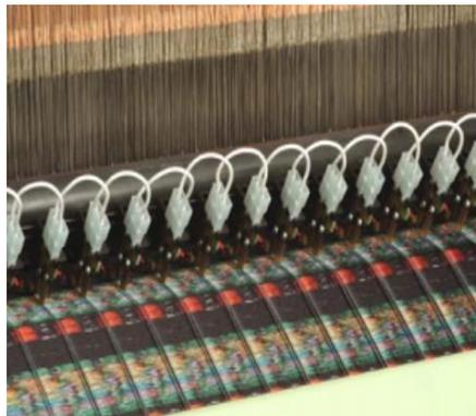
Cuchillas cortadoras térmicas para corte TVT2
