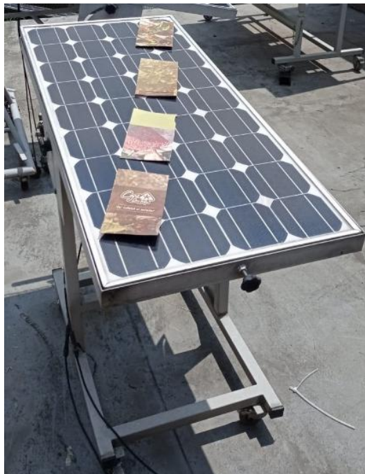
Figura 8. Panel PV con sombra diagonal, la simulación se realiza con cartones. Fuente: Autor.
