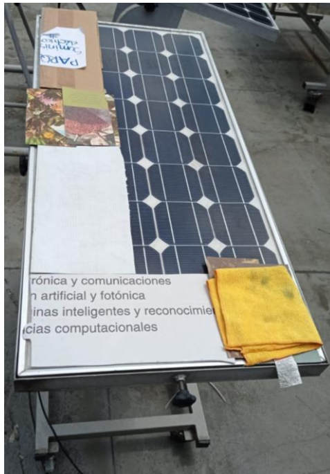
Figura 10. Panel PV con sombra en forma de L, la simulación se realiza con cartones. Fuente: Autor.
