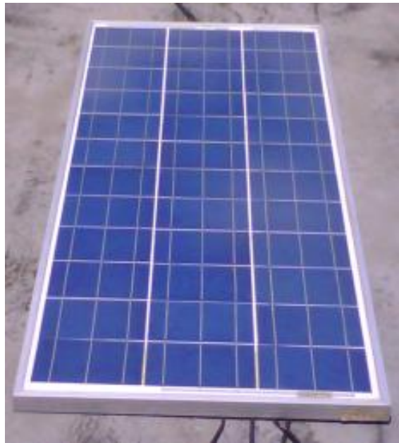
Figura 20. Panel PV sin sombra. Fuente: Autor
