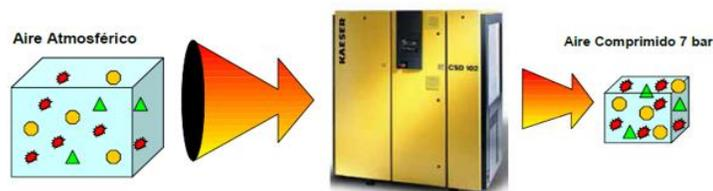
Figura 9. Suciedad del aire comprimido.
