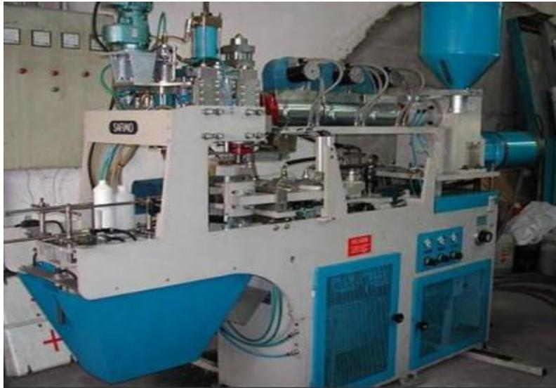
Figura 15. Máquina sopladora Safimo comprada por la empresa.
