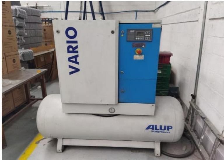
Figura 22. Compresor marca ALUP VARIO seleccionado para el sistema.
