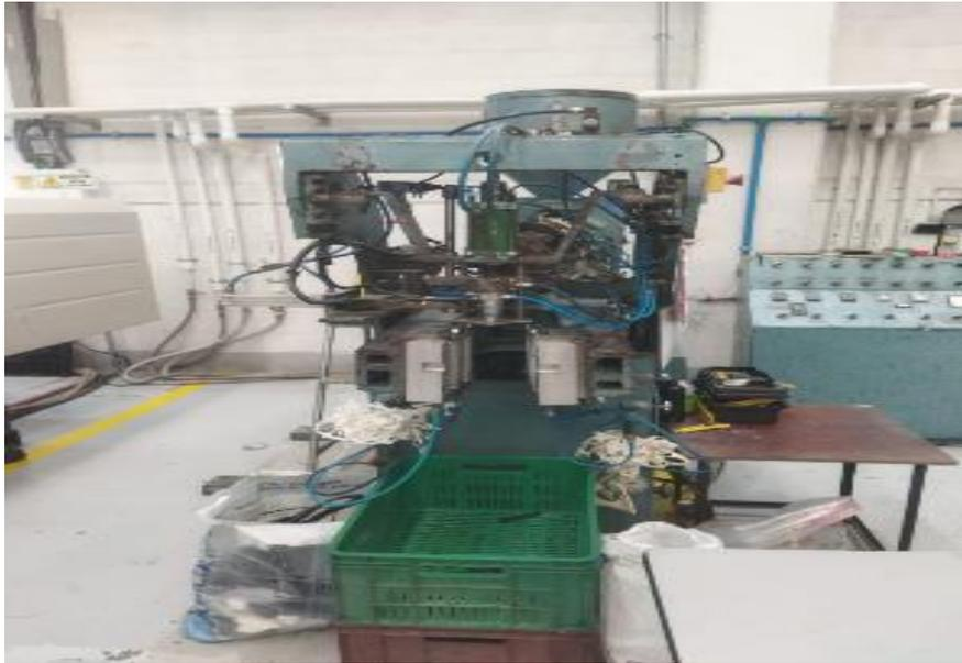
Figura 30. Máquina sopladora en mantenimiento.
