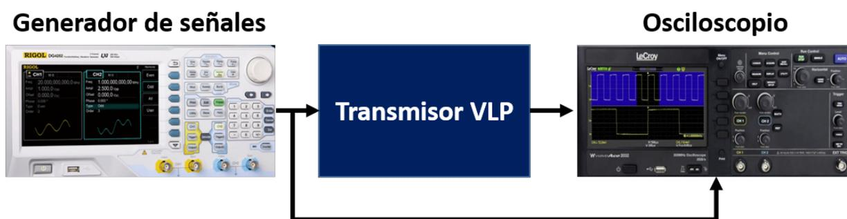
Figura 5-3: Procedimiento para estimar el ancho de banda del transmisor VLP.
