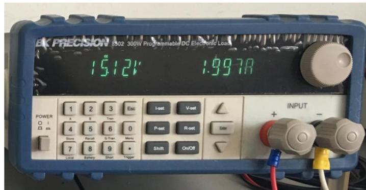
Figura 22. Generador de carga en corriente con valores da salida de convertidor Buck1.4.
