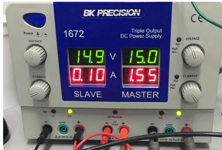
**Figura 59.** Fuente de voltaje con valores de alimentación para convertidor Boost 1.2. Elaboración propia.
