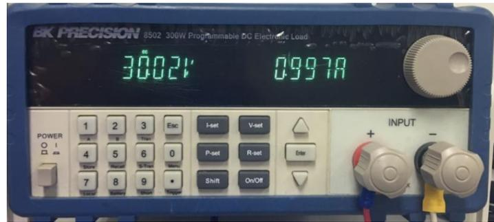
**Figura 41. Generador de carga en corriente con valores de salida convertidor Boost1.3.**
