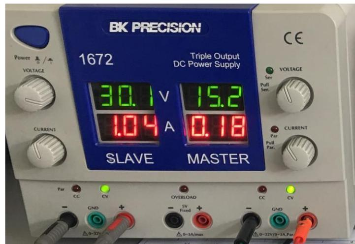
**Figura 21.** Fuente de Voltaje con valores de alimentación para el convertidor Buck 1.4. Elaboración propia.
