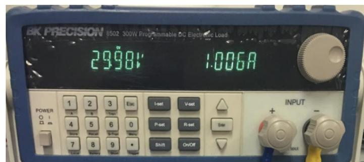
**Figura 47.** Generador de carga en voltaje con valores de salida convertidor Boost1.3.
