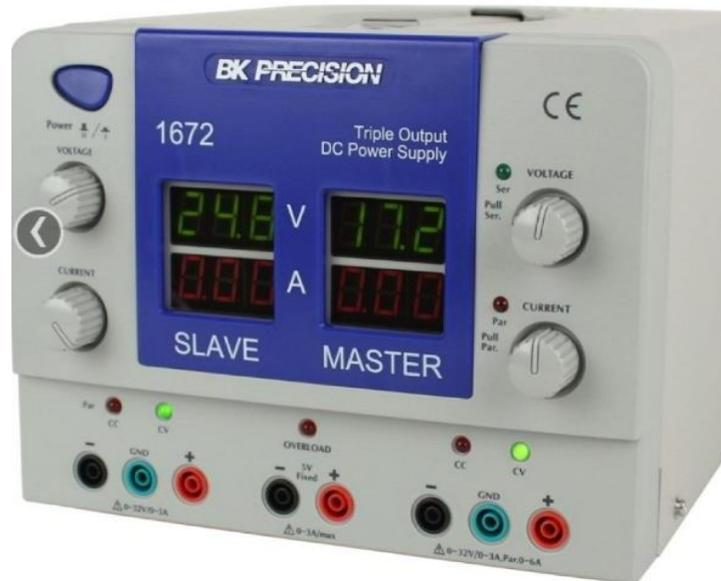
**Figura 15. Fuente de voltaje y corriente BK Precision Model 1672.**
