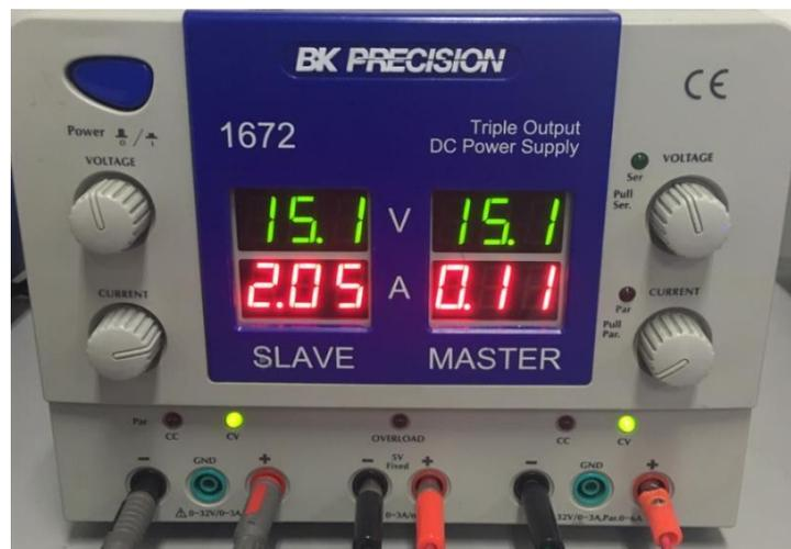
**Figura 40.** Fuente de voltaje con valores de alimentación para convertidor Boost 1.3. Elaboración propia.
