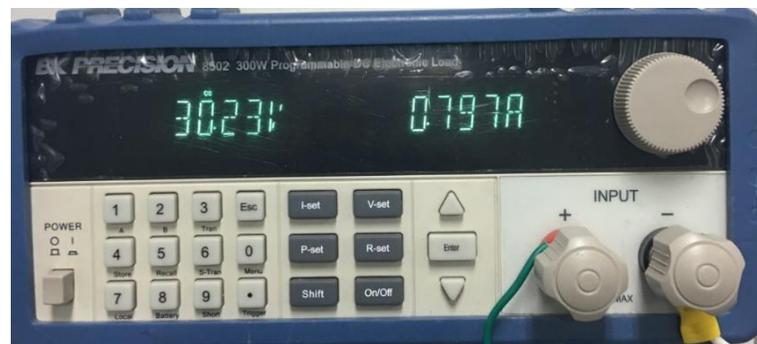
**Figura 60.** Generador carga en corriente con valores de salida de convertidor Boost 1.2.
