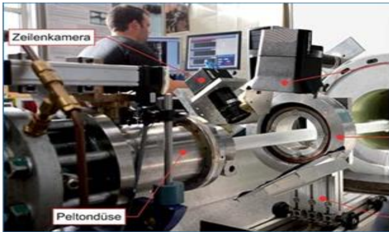
Figura 2. Dispositivo de medición laser. Imagen tomada de (Thomas Staubli, 2009)
