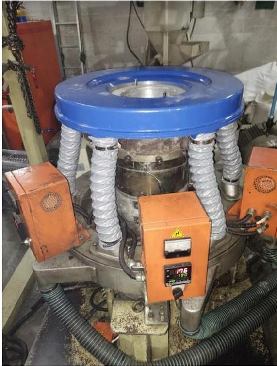
Figura 10. Extrusora #1 con cámara HDPE y plato de 12cm
