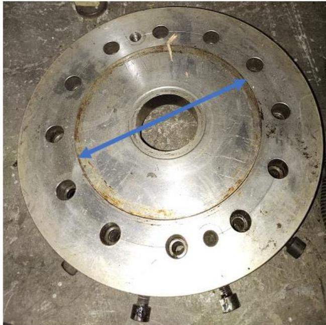
*Figura 9. Molde de extrusión mostrando el diámetro de ajuste*
