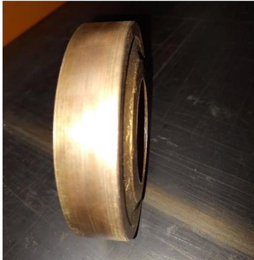
*Figura 16. Sello de bronce malo máquinas extrusoras. (numeral 15 de figura15)*
