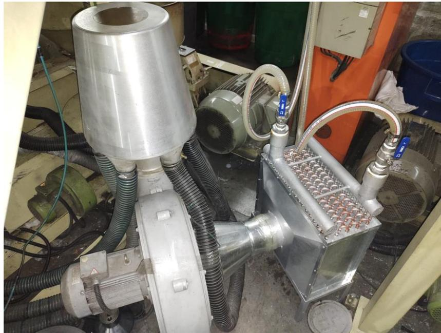
*Figura 14. Intercambiador montado en turbina de extrusora #2*
