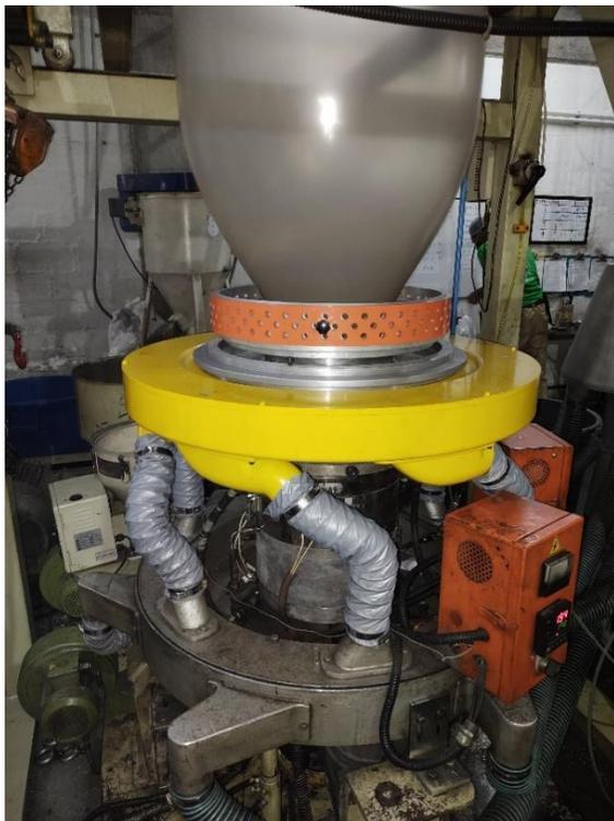
Figura 11. Cámara de aire LDPE en extrusora #1
